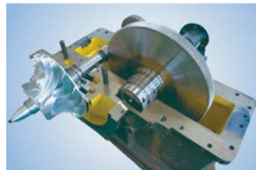
Рис № 30 Корпус редуктора с установленным валом с крыльчаткой и зубчатой передачей
