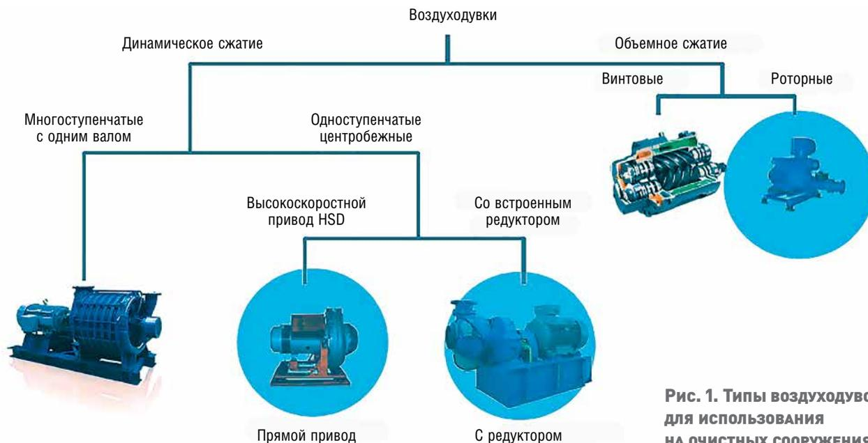
Рис. 1. Типы воздуходувок для использования на очистных сооружениях
