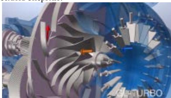
Рис № 05. Полностью открытые входные направляющие лопатки
