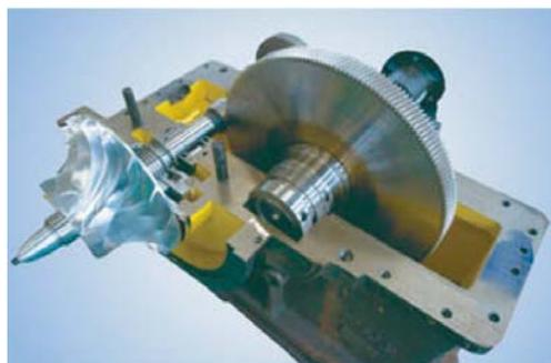
Рис № 11 Корпус редуктора с установленным валом с крыльчаткой и зубчатой передачей
