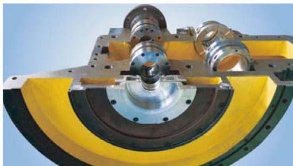
Рис № 10 Корпус редуктора
